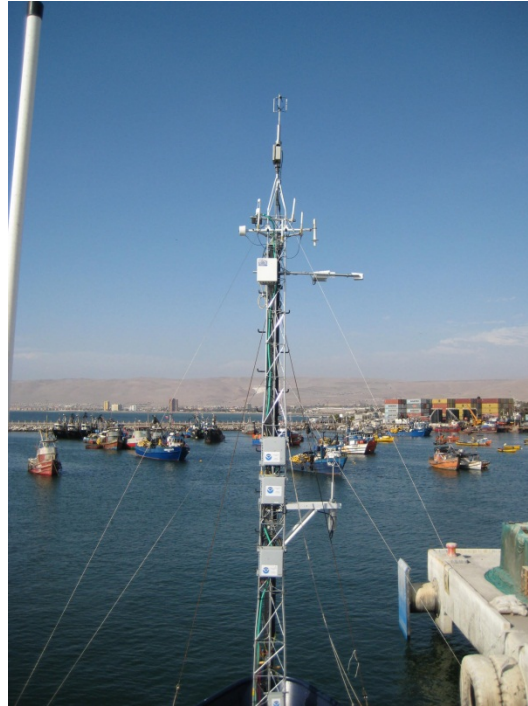
Figura 3-8. Sistema de Flujo de Turbulencia montado en la torre tras el “mástil de bandera” del Barco R/V Moana Wave . El anemómetro de turbulencia de WHOI está en el nivel inferior.
