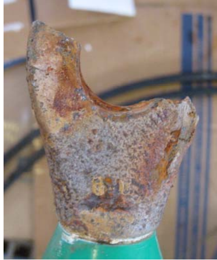
Figura 4-1. La parte de la boya Stratus 10 que falló, la cual estaba bajo los 45 m de profundidad en la barra del SBE37.
