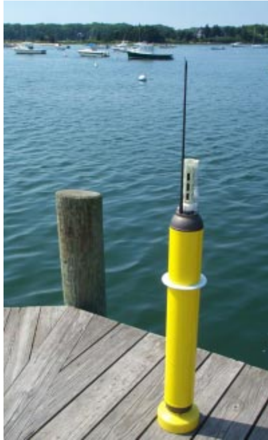
Figura 5-8. Boya Flotadora Apex Float, del tipo desplegado durante el crucero stratus 11.
