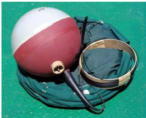
Figura 5-9. Típica boya derivadora de superficie
