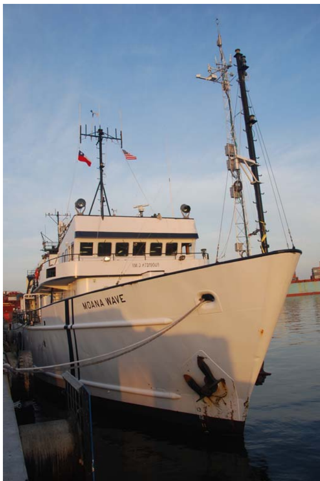
Figura 3-12. Foto del Moana Wave . La torre meteorológica de ESRL está instalada bajo el mástil de la proa, en la cubierta O1. El medidor sónico de viento está instalado en el mástil de proa y los sensores VOS están sobre la timonera.
