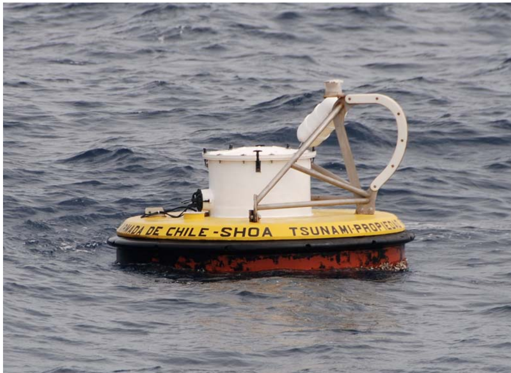
Figura 5-12. Boya de superficie DART II inspeccionada durante el crucero Stratus 11.
